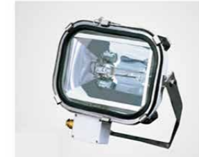
投光灯: WTG18 / Spot light 220V/50Hz 220V/60Hz 200/300/500W 3300-8500lm R7s タンクステンハロゲンランプ φ 12~φ 14 IP67 5.8kg
