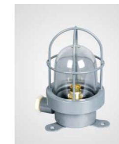
錨灯: WCXH8-2 / Anchor light 製品サイズ: φ 125 × 150 2n.m 360° B15D 24V/15W 24V/30W IP55 Aluminum 透明 0.75kg
