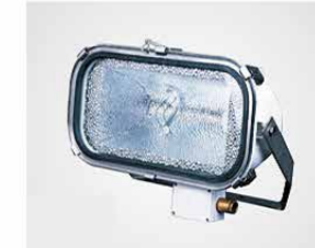
投光灯: WTG25 / Spot light 220V/50Hz 220V/60Hz 250/400W 3300-8500lm E40 高圧ナトリウムランプ φ 12~φ 14 IP67 5.8kg
