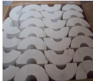
高性能硅酸钙保温材料 / High-performance calcium silicate thermal insulation material
